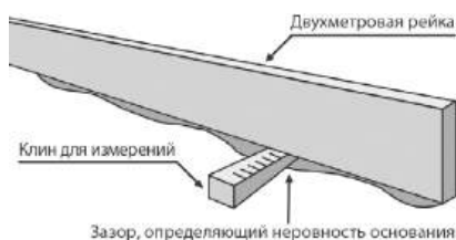
Рис. 1. Измерение неровности основания
